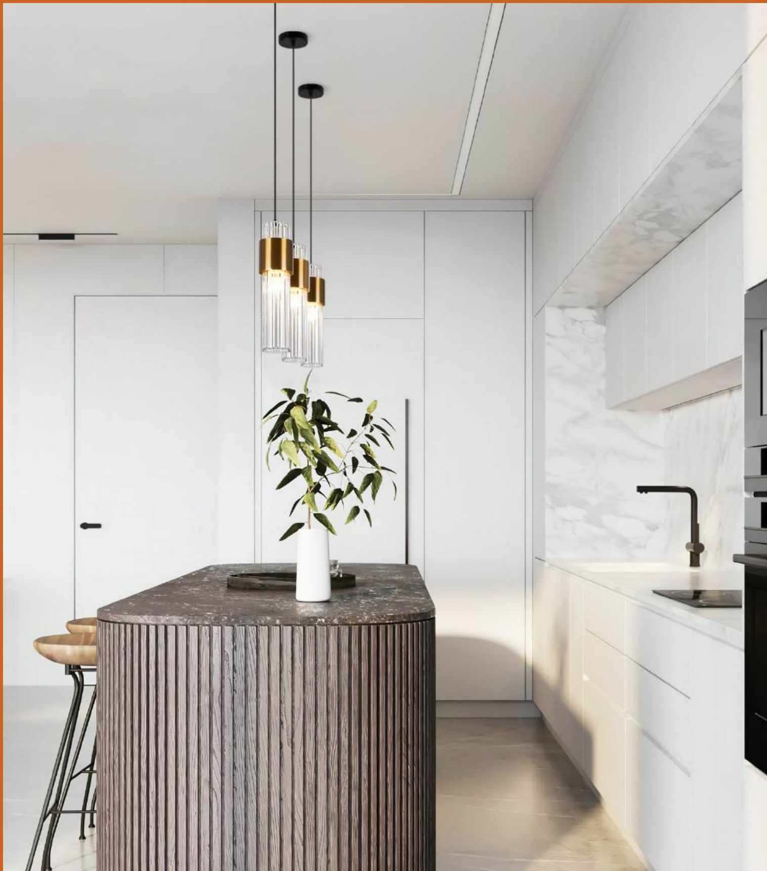
Арматура из металла черного цвета. Плафон — прозрачное ребристое стекло цилиндрической формы. Декоративная металлическая вставка золотого оттенка. Источник света — лампа с цоколем E14.
